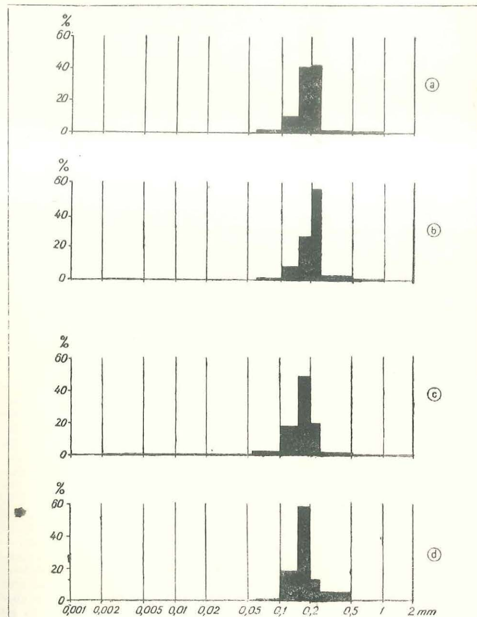
Fig. 1. Granulometria citorva nisipuri din peninsula Chituc. a. Profil 20, proba 10—20 cm; b. Profil 20, proba 60—80 cm; c. Profil 18, proba 60—80 cm; d. Profil 17, proba 20—30 cm. Pe abscisă: fracțiuni granulometrice (dimensiunile redată în scară logaritmică). Pe ordonată: conținutul în diferite fracțiuni granulometrice, exprimat în procente.
