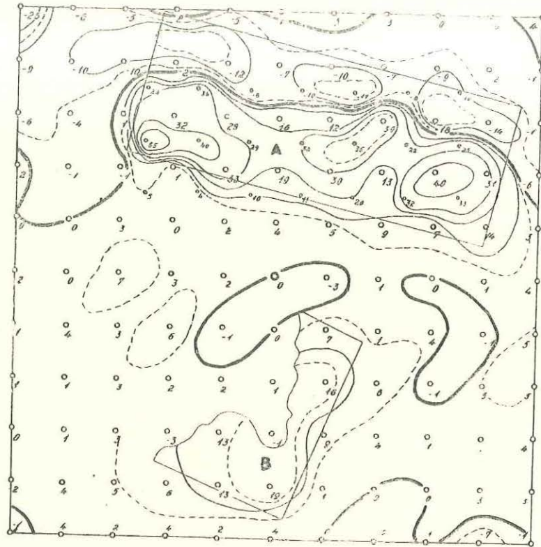
Fig. 2. Panou micromagnetic situat pe aluviuni cuaternare din perimetrul cărămidărilor țărănești a localității Teliu (Țara Birsei), cuprinzînd efectul magnetic a două vetre pentru ars cărămizi.
